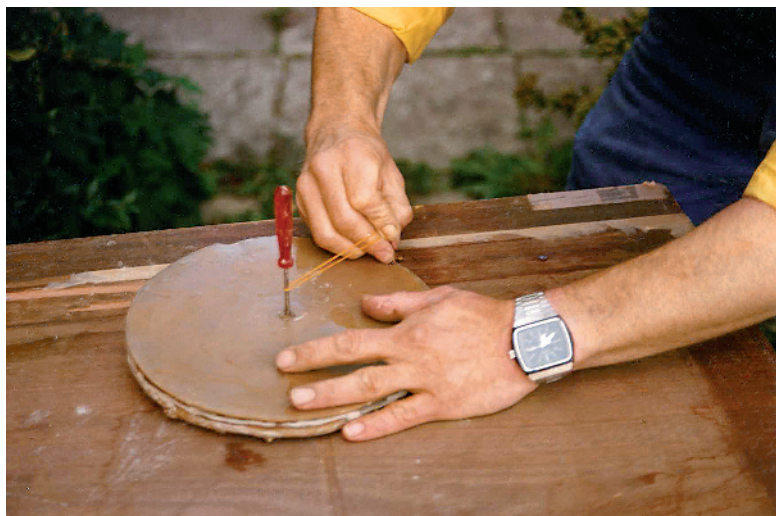
Fig. 1. Vokspladen finpudses i kanterne og lægges på en træplade, der kan drejes. Pladen centrerer i forhold til en syl, som sættes i midten. I sylen bindes en snor forbundet med et redskab, der kan være af træ, ben eller andet med en tilskåret æg, som kan skære fine linjer, der kan danne koncentriske cirkler i voksen.
